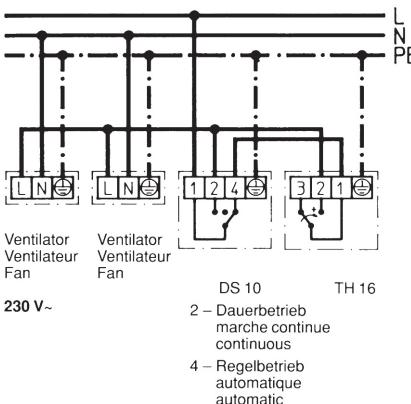
Steuerung eines oder mehrer Ventilatoren über Thermostat und – wahlweise – Drehschalter DS 10, für Dauerbetrieb – Aus – Regelbetrieb.
