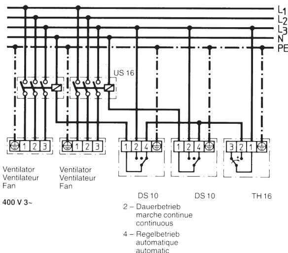
Steuerung mehrer Ventilatoren über Thermostat, Schütz US 16 und – wahlweise – mit Schaltung jedes einzelnen Ventilators über Drehschalter DS 10, für Dauerbetrieb – Aus – Regelbetrieb.
