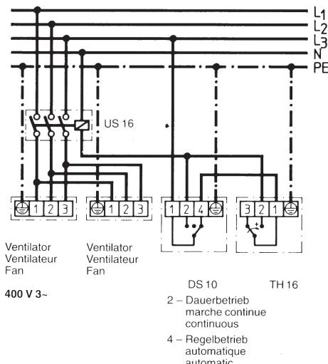
Steuerung eines oder mehrer Ventilatoren über Thermostat, Schütz US 16 und – wahlweise – Drehschalter DS 10, für Dauerbetrieb – Aus – Regelbetrieb.
